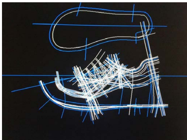
Obr. 18 – Konstrukce šablon v systému CadCobbler
