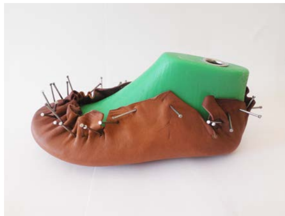
Obr. 16 – Příprava tříslučiněnné usně na podešev
