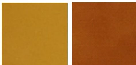
Obrázek 36: Porovnání filmů síťovaných dialdehydem celulózy, vlevo film s přísávkem 8 % DAC a 10 % GLY, vpravo film s přísávkem 20 % DAC a 20 % GLY.
