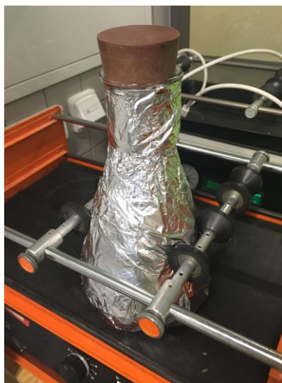
Obrázek 25: Erlenmayerova baňka obalená aluminiovou folií, umístěná na třepačce.
