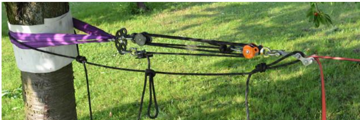
Obr. 43: prípad lanového kladkostroja s pomerom 5: 1
