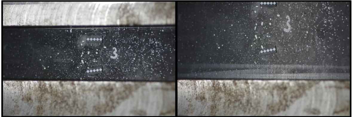
Obr. 71 Snímky smykové zkoušky 3. vzorku před (vlevo) a po deformaci (vpravo)
