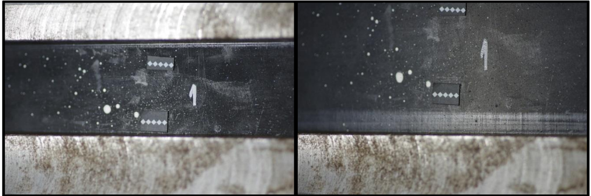
Obr. 61 Snímky smykové zkoušky 1. vzorku před (vlevo) a po deformaci (vpravo)
