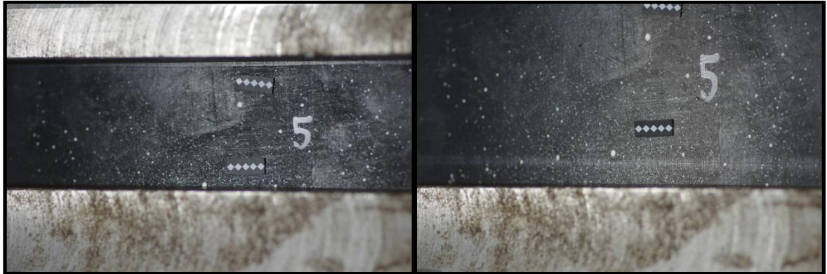
Obr. 81 Snímky smykové zkoušky 5. vzorku před (vlevo) a po deformaci (vpravo)
