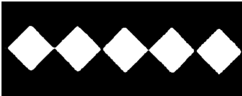
Obr. 26 Pásek s body potřebnými ke snímání deformace
