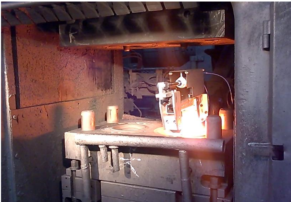
Obr. 91 Založení pěchu do předkovací dutiny v pracovním prostoru
