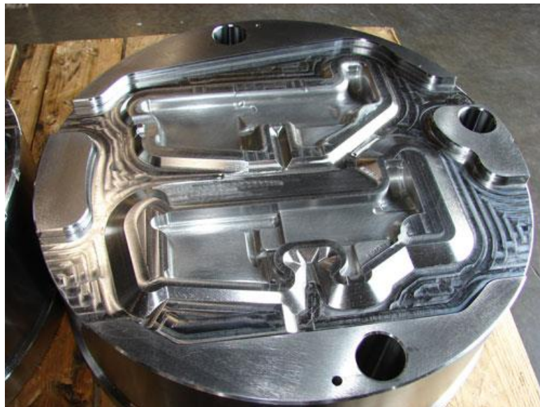
Obr. 7 Kovací zápustka vyrobená frézováním
