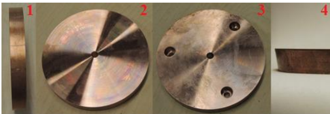
Obr. 6.6 Postup výroby tvarových dutin
