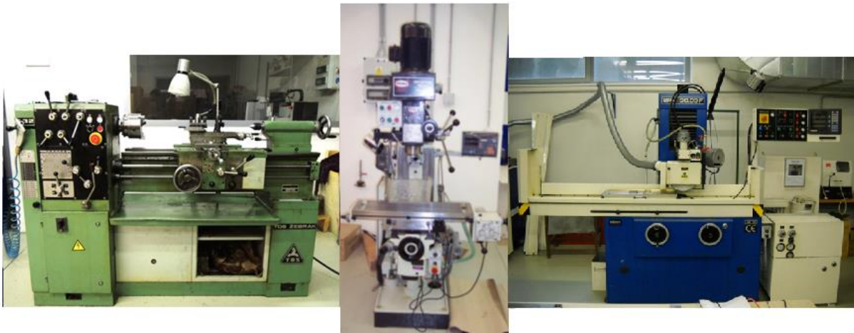
Obr. 6.7 Soustruh TOS S32, univerzální frézka FHV-50PD, bruska BRH 20.03F
