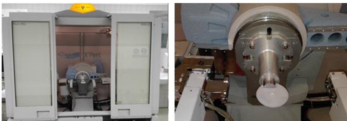
Obr. 6.3 Difraktometr X'PERT PRO a ukázka uchycení vzorku
