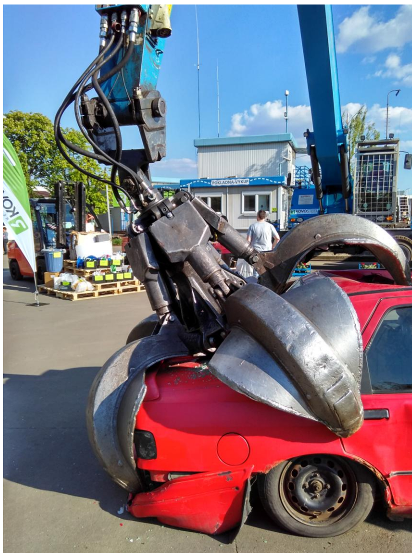
Obrázek 6 – Detail hydraulického drapáku [vlastní]
