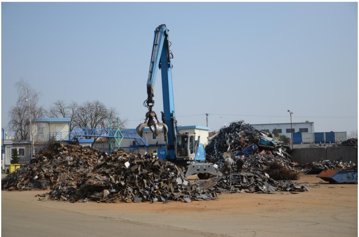
Obrázek 9 – Manipulační zařízení značky Fuchs s drapákem zpracovávající kovový šrot [Kovosteel Recycling s.r.o.]
