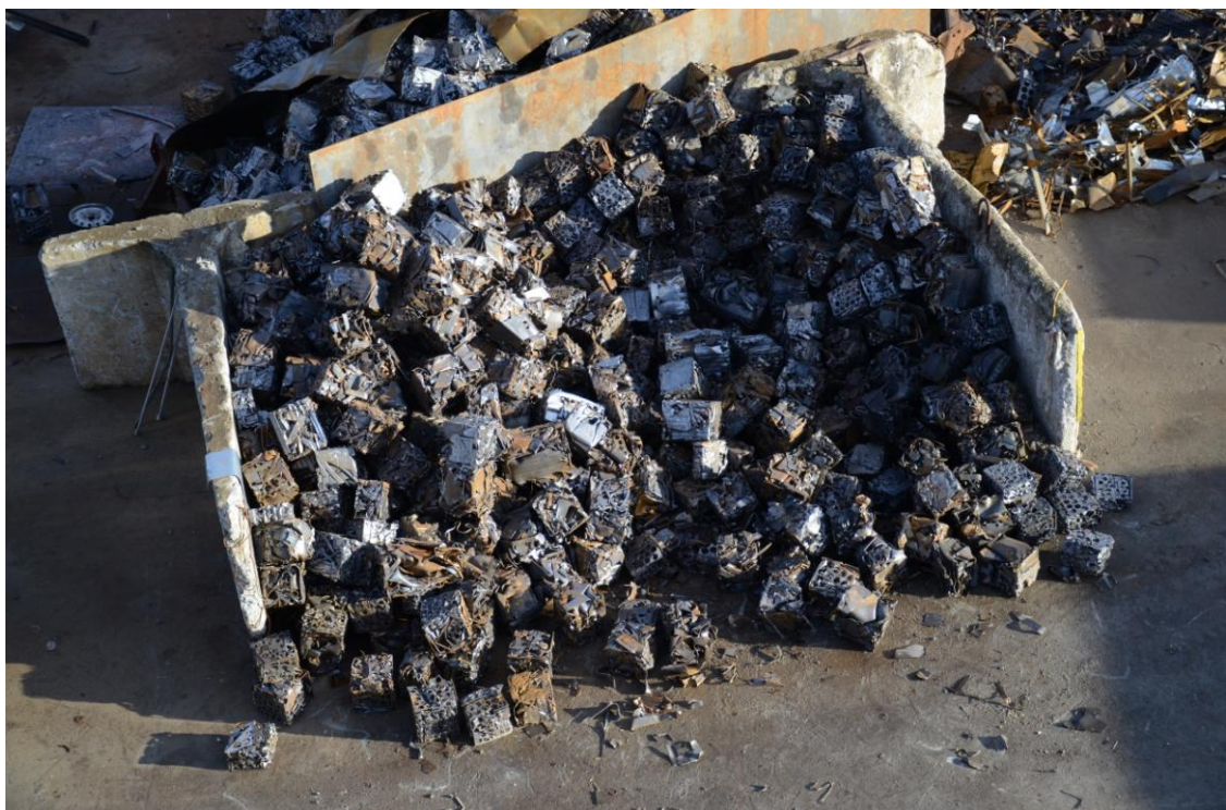
Obrázek 5 – Nalisované balíky Fe, které jsou připraveny na roztavení [Kovosteel Recycling s.r.o.]
