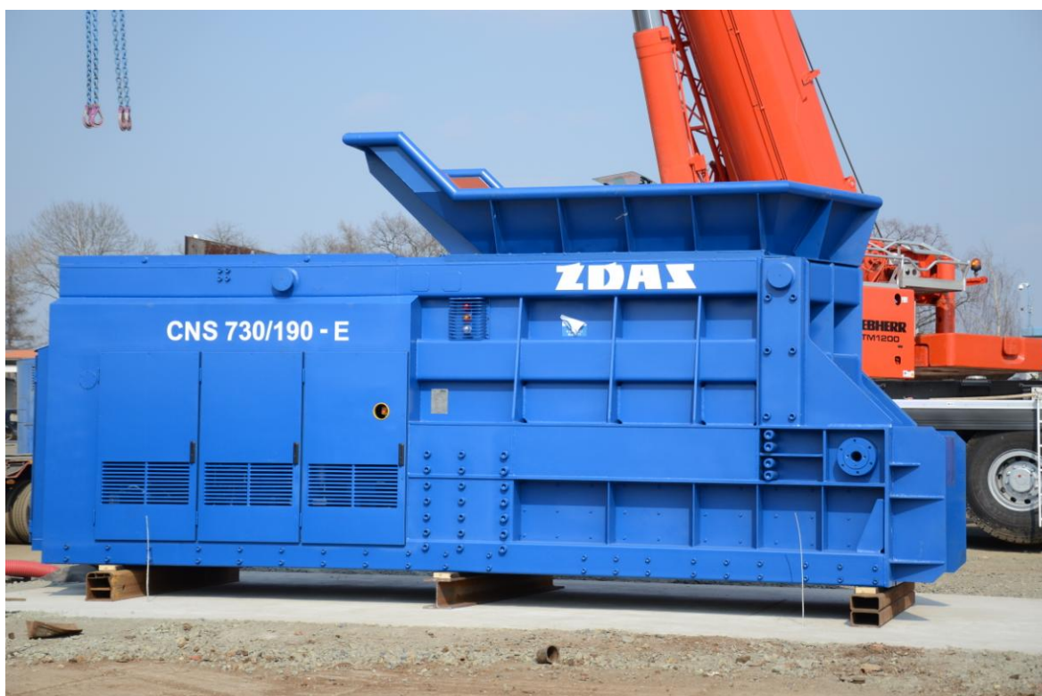
Obrázek 7 – Hydraulické nůžky na stříhání železa [Kovosteel Recycling s.r.o.]
