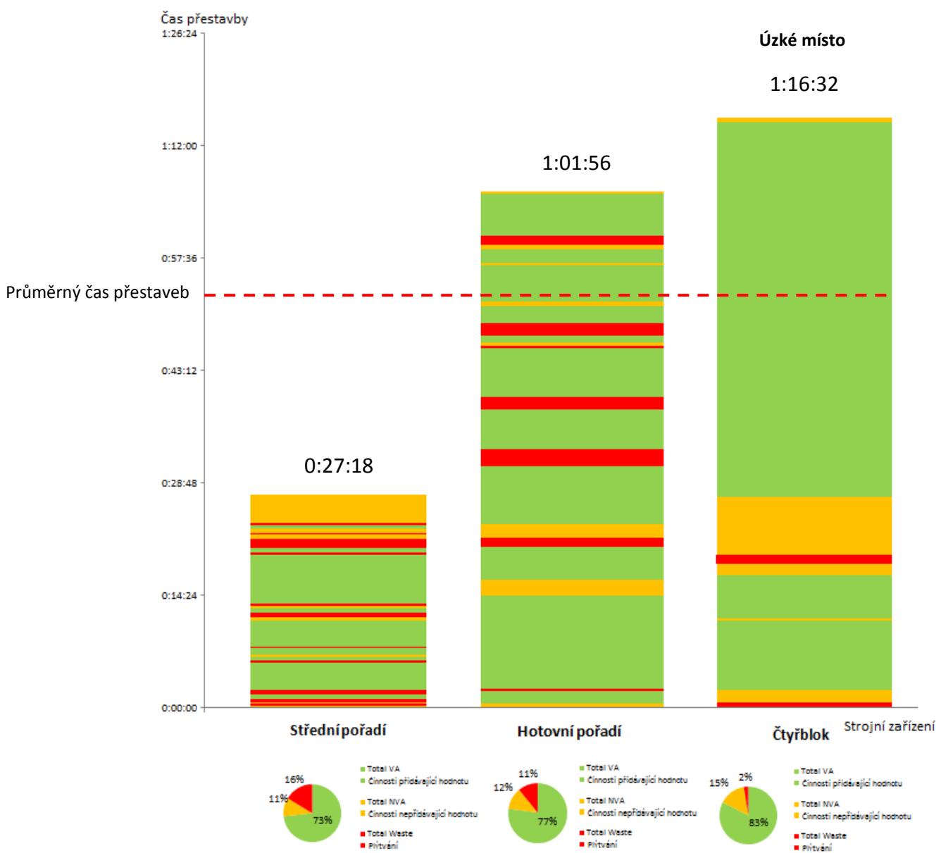
Obrázek 21 Yamazumi diagram - celá přestavba podle starého JŘ (5,5-6 mm)
