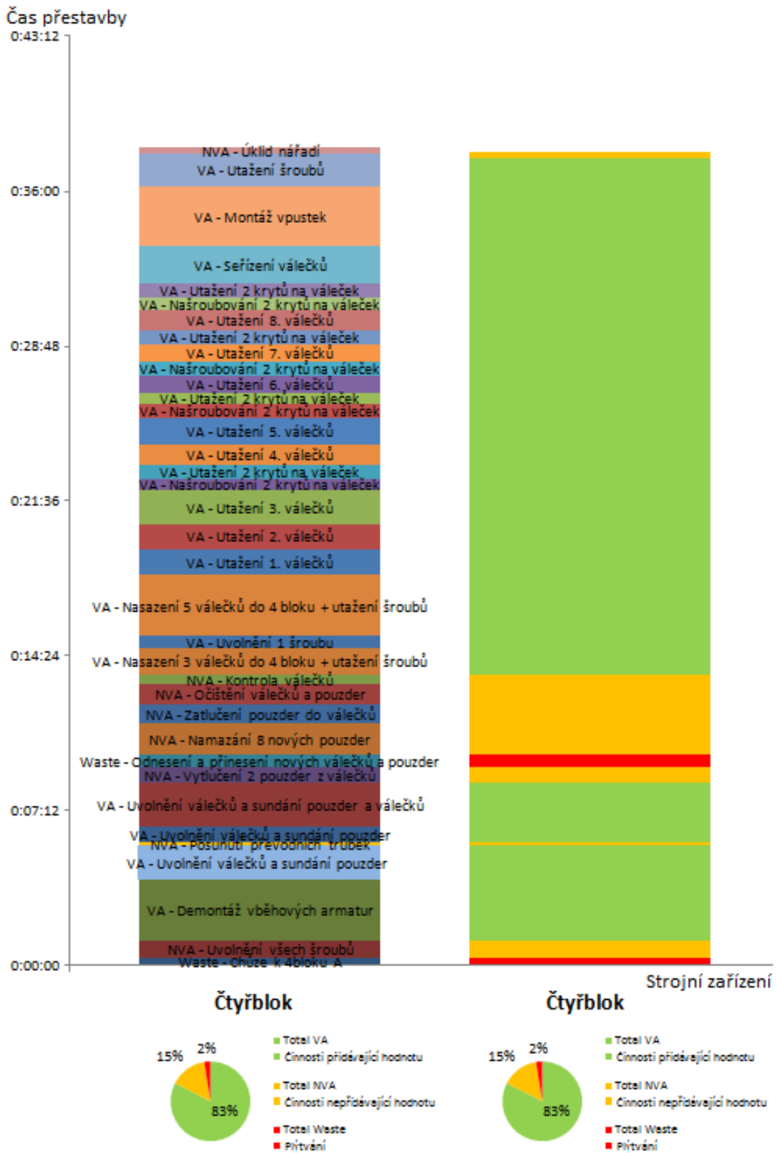
Obrázek 18 Yamazumi diagram - původní přestavba stolice čtyřbloku A (5,5-6 mm)
