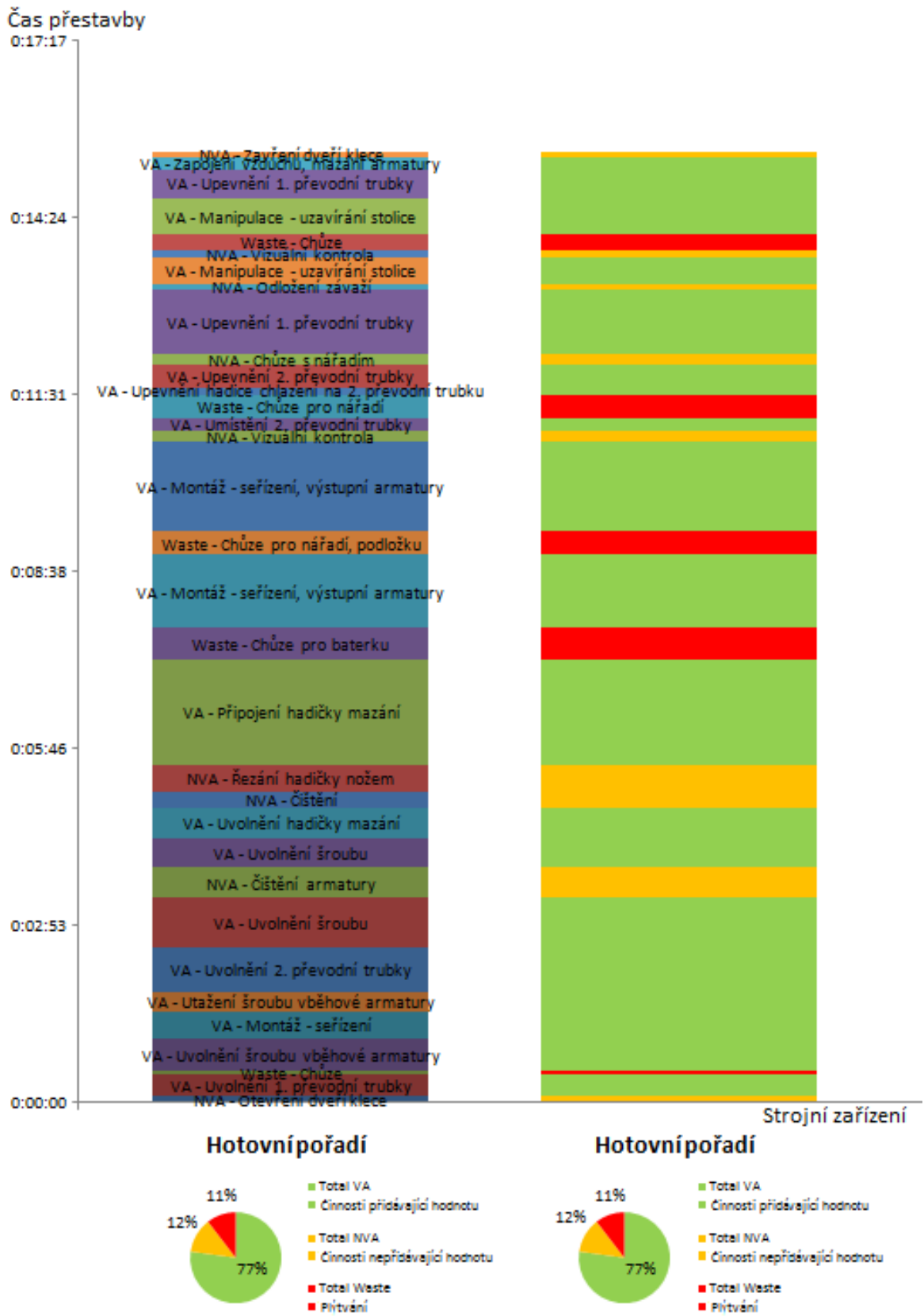
Obrázek 16 Yamazumi diagram - původní přestavba stolice hotovního pořadí (5,5-6 mm)
