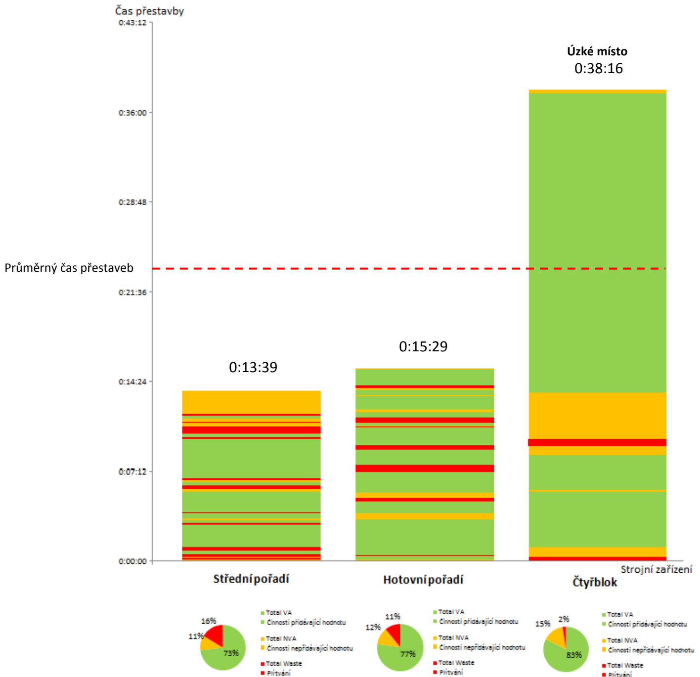
Obrázek 20 Yamazumi diagram - srovnání doby přestavby jednoho zařízení na jednotlivých pořadích u původní přestavby 5,5-6 mm
