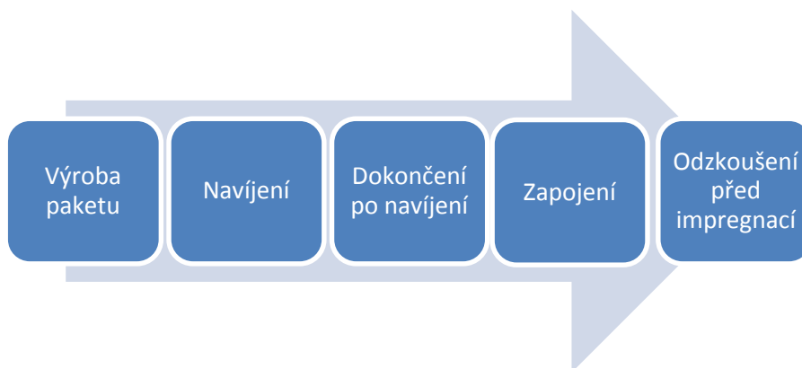
Obrázek 26: Jednotlivé pozice na pracovišti kotev (vlastní zpracování)
