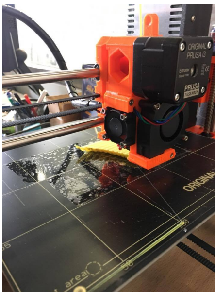
Obr. 8. Tisk pomocí FDM tiskárny prusa mk3
