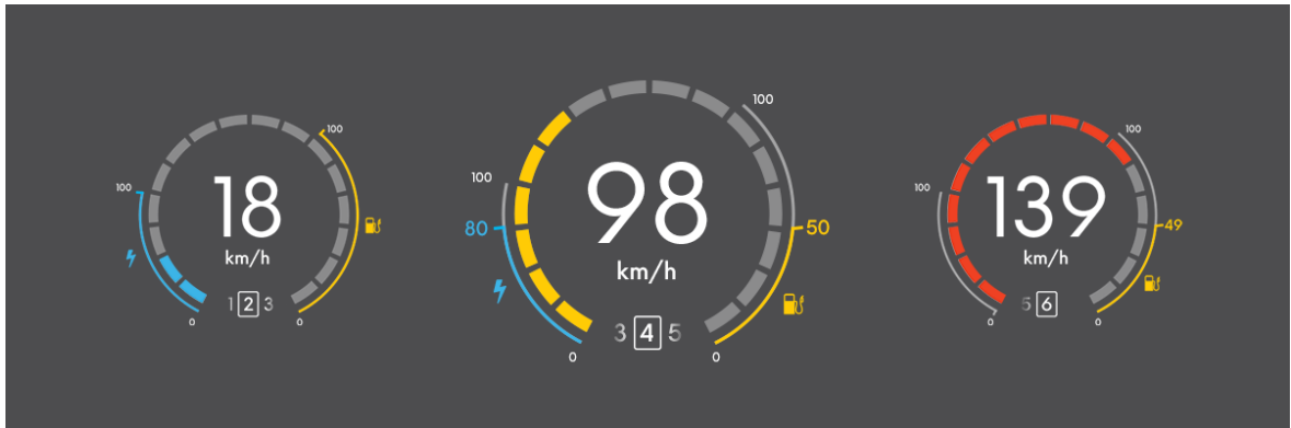
Obrázek 7 – Různé stavy ukazatele akcelerace, baterie, paliva a tachometru
