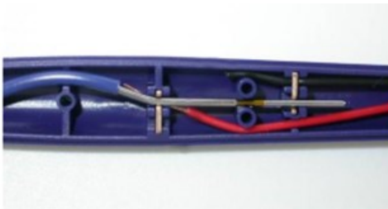
Obr. 32 Sestavení sondy (interní materiály společnosti)
