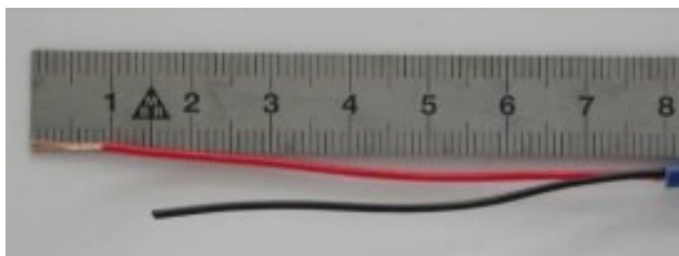
Obr. 31 Příprava vodičů připojovacího kabelu (interní materiály společnosti)
