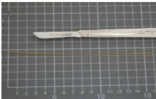
Obr. 23 Řezání vnitřní izolace (interní materiály společnosti)
