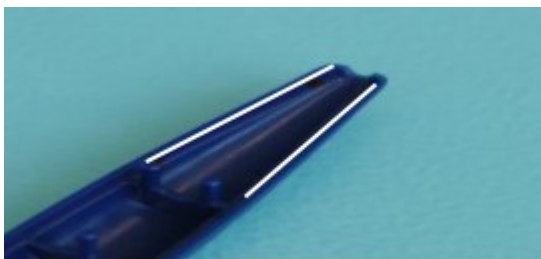
Obr. 33 Lepení ruček (interní materiály společnosti)
