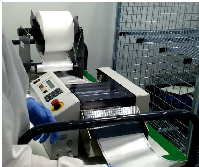
Obr. 36 Řezání sáčků (interní materiály společnosti)
