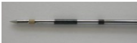
Obr. 26 Navléknutí vnějšího vodič (interní materiály společnosti)
