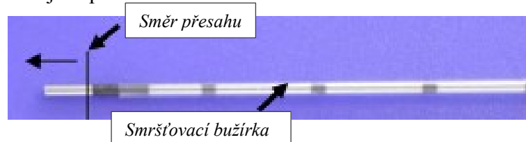
Obr. 21 Navlékání smršťovací izolace na vnější vodič (interní materiály společnosti)
