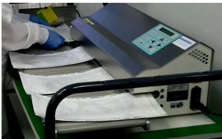
Obr. 37 Sváření sáčků (interní materiály společnosti)
