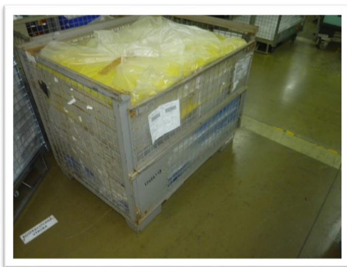
Obrázek 26 Ukládání pomocí Gitter boxu (vlastní zpracování)
