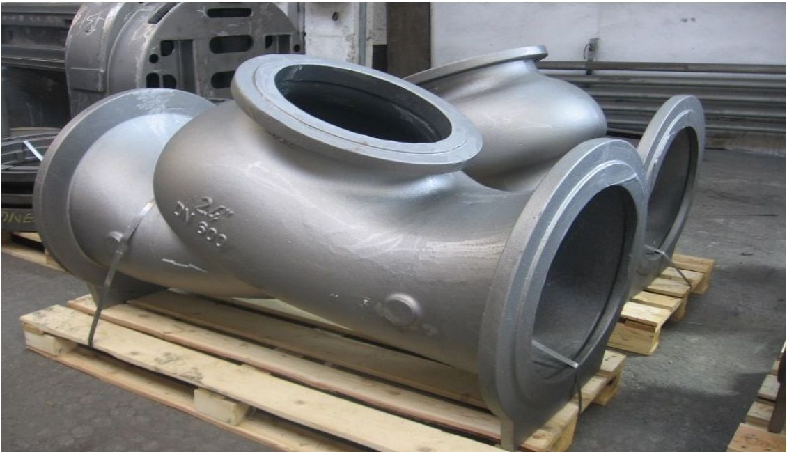
Obrázok 13 Ventil, EN-GJS-400-15, 1075 kg, (ZPS – Slévárna, © 2015)
