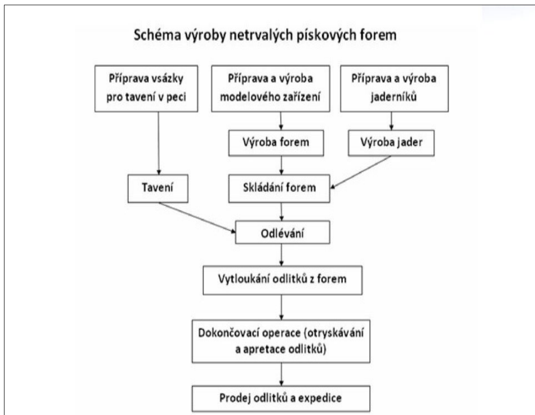
Obrázok 2 Typický postup zlievarenskej výroby (Nová, Machuta, © 2017)
