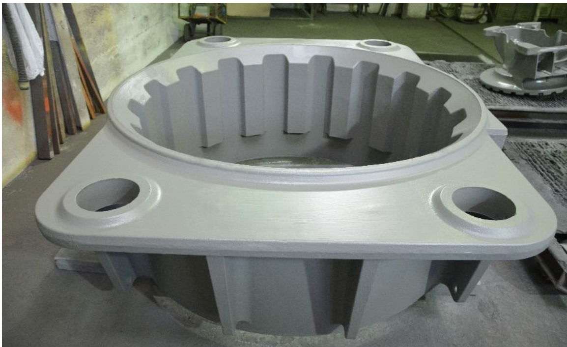
Obrázok 14 Základňa rotoru, EN-GJL-250, 4270 kg, (ZPS – Slévárna, © 2015)
