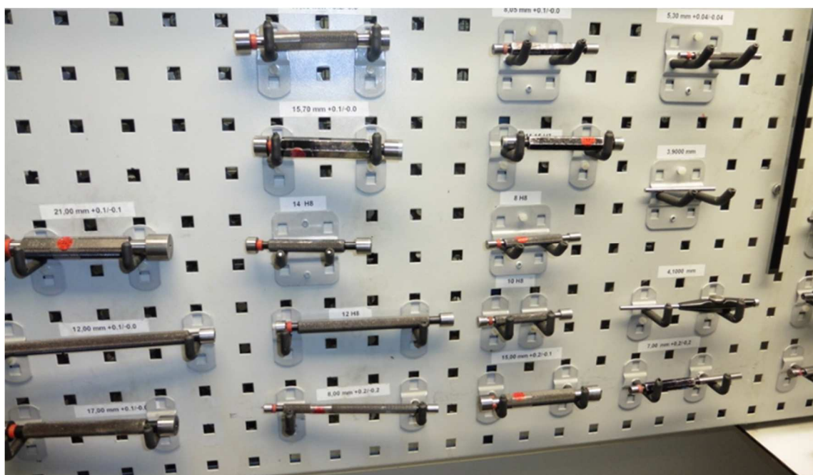
Obrázek č. 12 – Kontrolní válečkové kalibry (vlastní zpracování)
