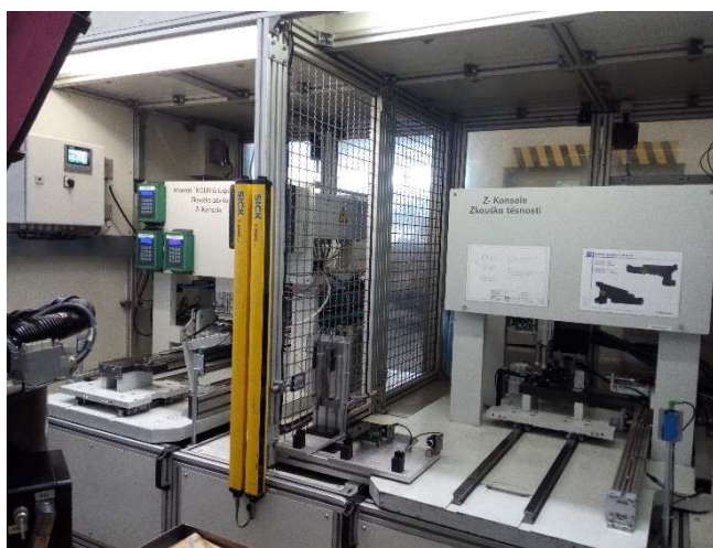
Obrázek č. 19 – Zkouška správnosti závitů a zkouška těsnosti (vlastní zpracování)
