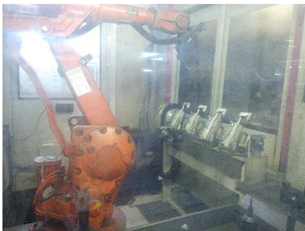
Obrázek č. 18 – Robot a nakládání do stroje (vlastní zpracování)
