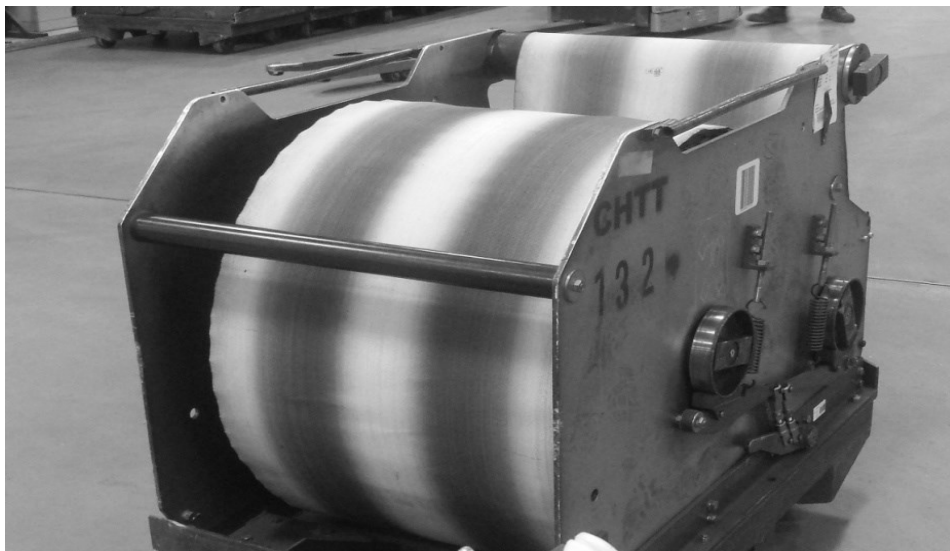
Obrázok 16 Kazeta s dvoma kusmi bočnic – 65 m návin (interný zdroj)
