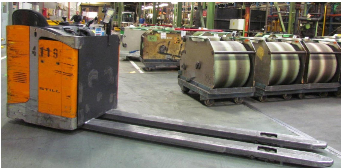
Obrázok 18 Transportný prostriedok na prepravu kaziet s bočnicami (vlastné spracovanie) Okrem transportu polotovarov zabezpečujú tiež distribúciu kanbanových kariet a asistujú pri výmene akubaterie.
