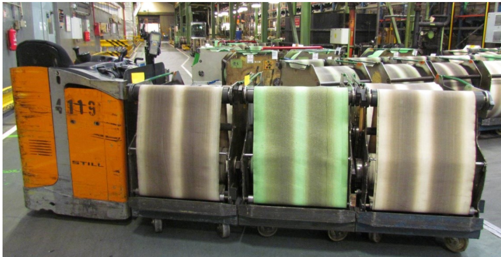
Obrázok 19 Kazeta na prepravu polotovarov – bočníc (vlastné spracovanie)
