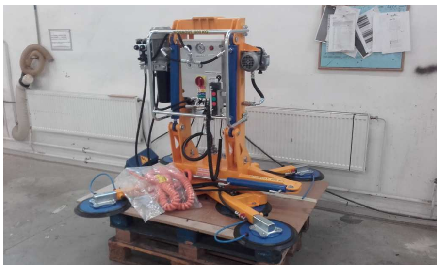
Obr. 16 Ovládací a uchycovací část vakuového jeřábu (vlastní zpracování)
