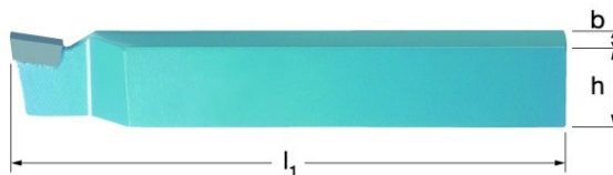
Obr. 54. Soustružnický nůž upichovací 25x16x145 mm P20 pravý [16]
