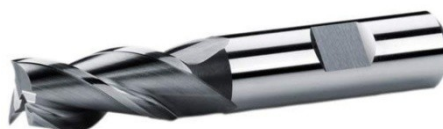
Obr. 58. Fréza válcová čelní 3bř. Ø20x38 mm [16]
