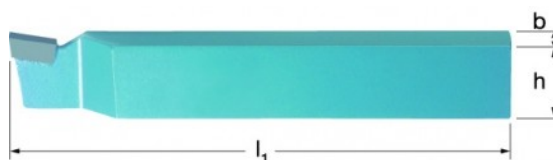
Obr. 53. Soustružnický nůž upichovací 20x12x125 mm P20 pravý [16]
