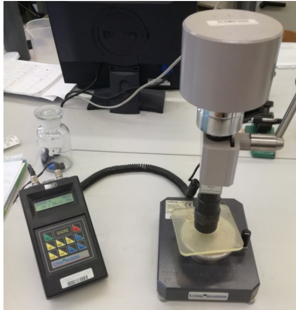
Obr (40) Zkouška tvrdosti na zařízení BAREISS BS61-II
