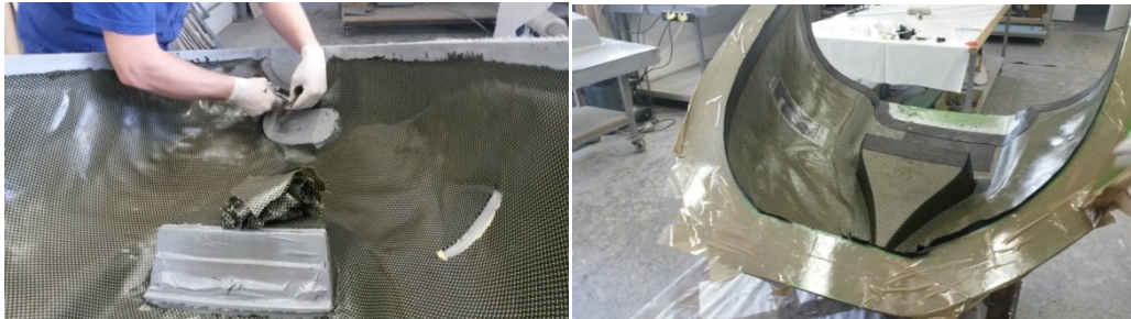
Obr (34) Kladení druhé vrstvy tkaniny aramid-uhlík a uhlíkového pásu
