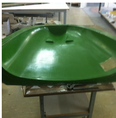
Obr (31) Připravená forma pro ruční laminaci
