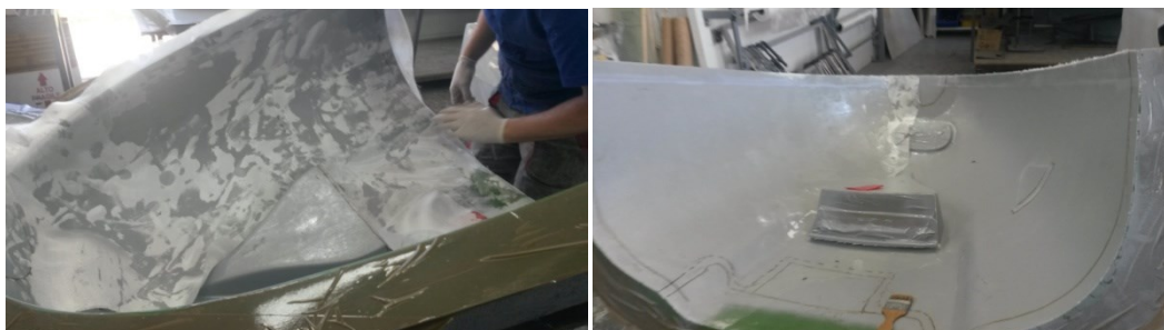
Obr (32) Kladení vrstvy skelné tkaniny
