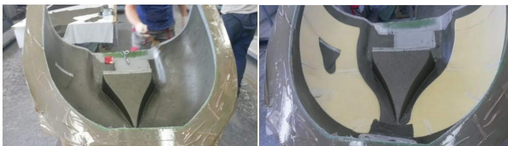
Obr (33) Kladení vrstvy tkaniny aramid-uhlík a pěnového jádra
