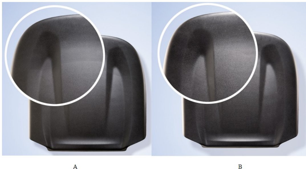
Obrázek 28. A - vzhledová váda při použití klasického vstřikování, B – stejný díl bez vad s použitím SynFlow [19]
