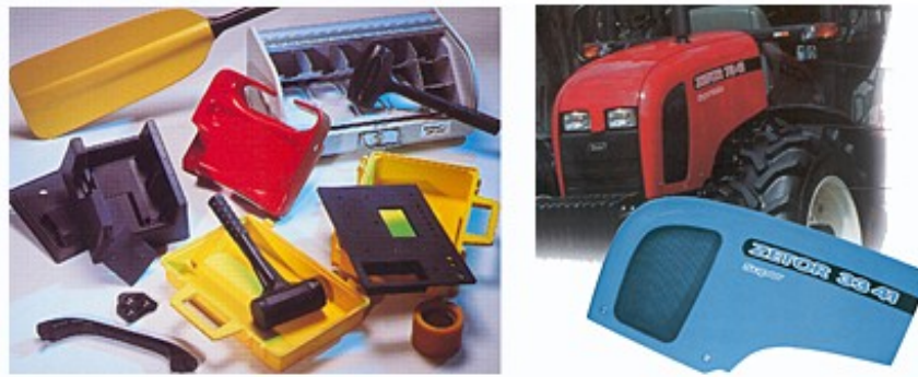
Obrázek 22. Aplikace výrobků reakčním vstřikováním [2]
