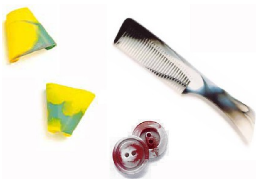
Obrázek 18. Aplikace výrobků metodou intervalového vstřikování [2]
