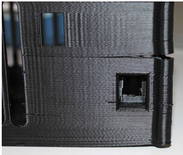
Obr. 33 Popraskaný výtisk vlivem deformace [3]
