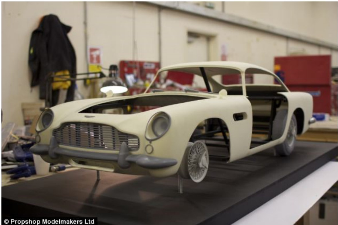
Obr. 7 Vytištěný Aston Martin DB5 v měřítku 1/3 [11]
