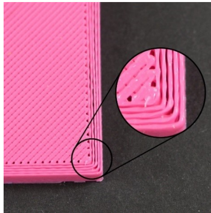
Obr. 48 Chybějící materiál na výtisku [49]
