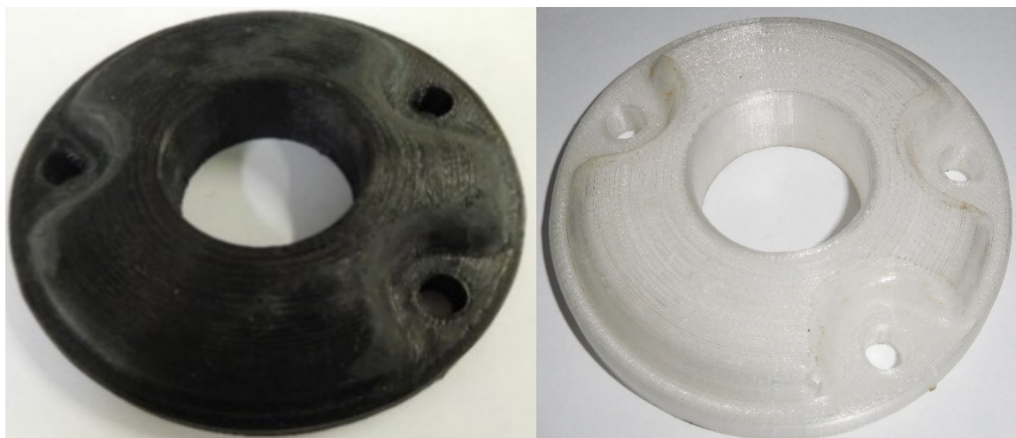
Obr. 91 Vytištěný druhý tlumicí přípravek z materiálů Flexfill 98A (černý) a Flexfill 92A (bílý)
