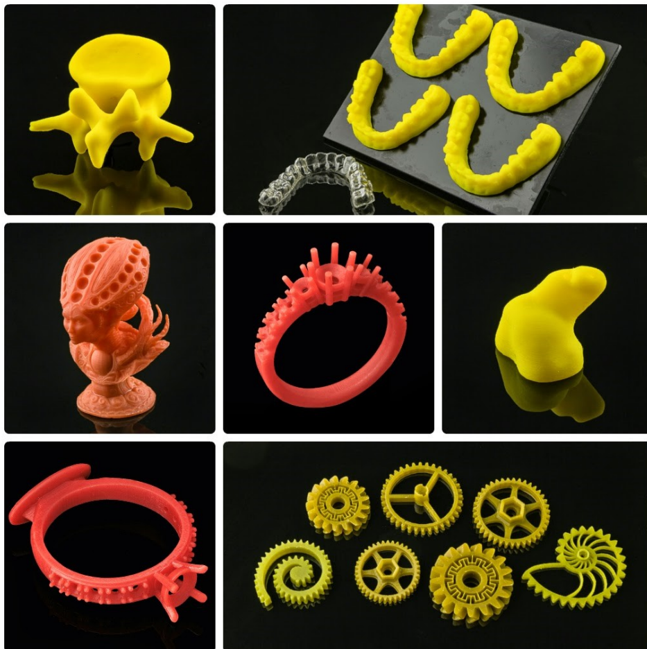
Obr. 19 Objekty vytištěné technologií DLP Projection [20]
