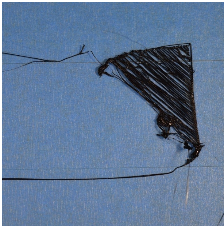
Obr. 47 Nepřilepená první vrstva k tiskové podložce [49]
