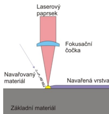
Obr. 87 Princip navařování laserem
