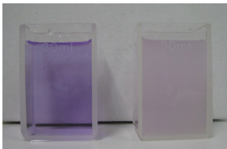
Obrázek 64 Reakce krystalové violeti s hydroxidovými anionty, levá kyveta QC10Br, pravá kyveta QC16Br, čas 18. minuta
