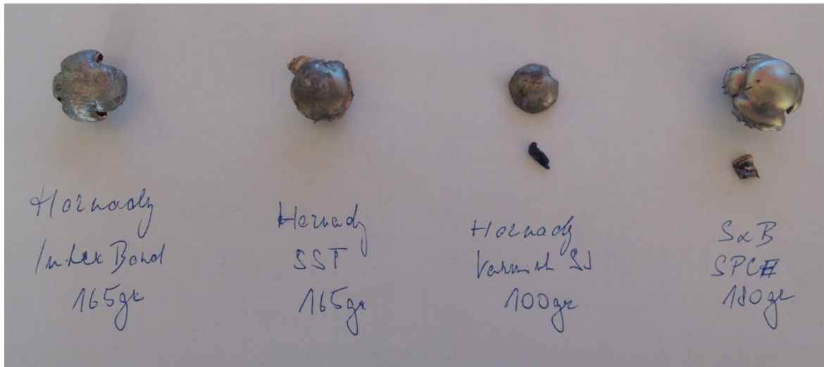
Obrázek 75 Srovnání průřezu střel InterBond, SST, SJ a SPCE po deformaci
