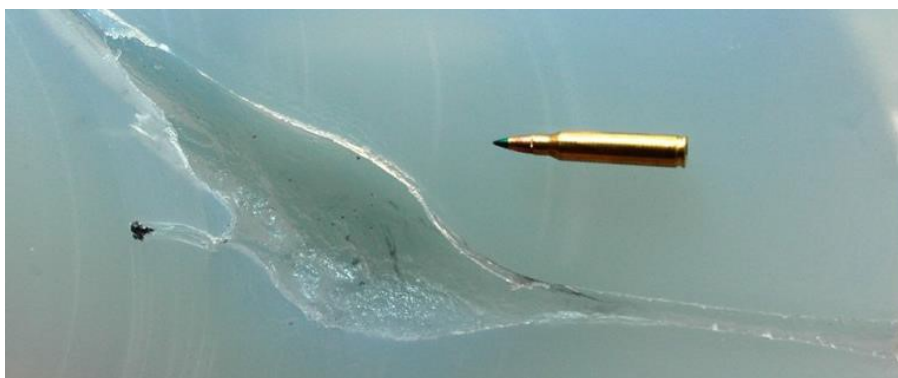
Obrázek 18 Trvalá kavita v balistickém mýdle
