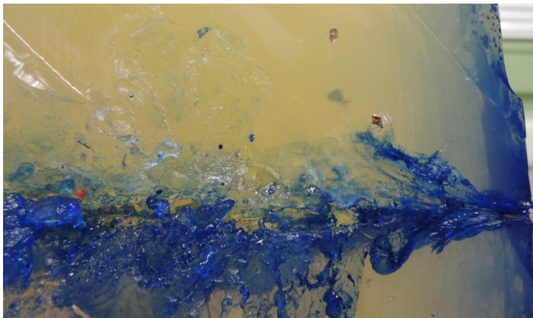
Obrázek 56 Detail střepin po průniku střelou InterBond
