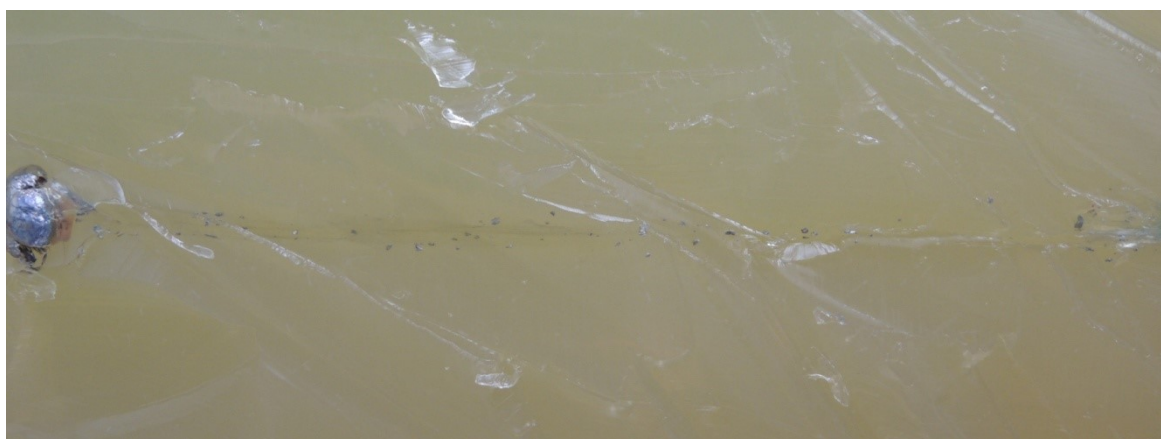
Obrázek 57 Detail otěru olova ve střelném kanálu
