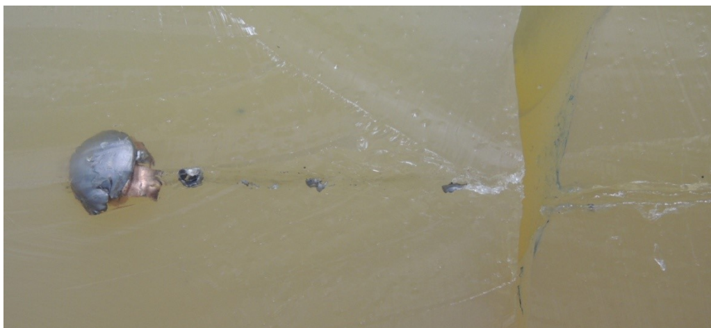
Obrázek 69 Detail střelného kanálu s fragmenty olova
