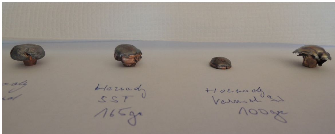
Obrázek 76 Srovnání střel InterBond, SST, SJ a SPCE po deformaci
