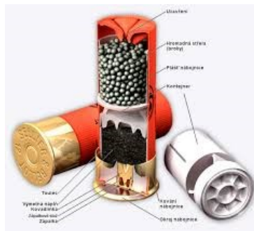
Obrázek 28 Řez brokovým nábojem
