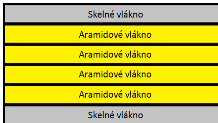
Obr. 15 Schéma uložení tkanin v kompozitním systému
