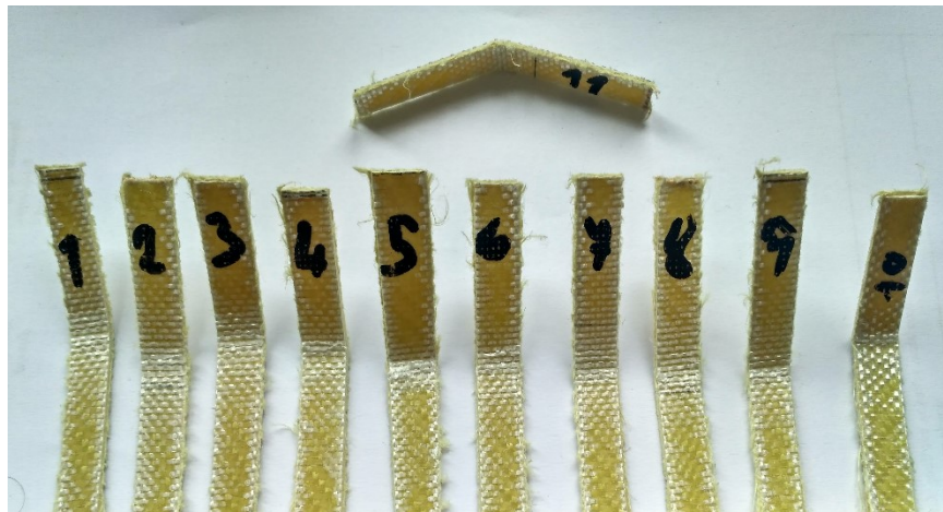
Obr. 36 Zkušební vzorky po tahové zkoušce
