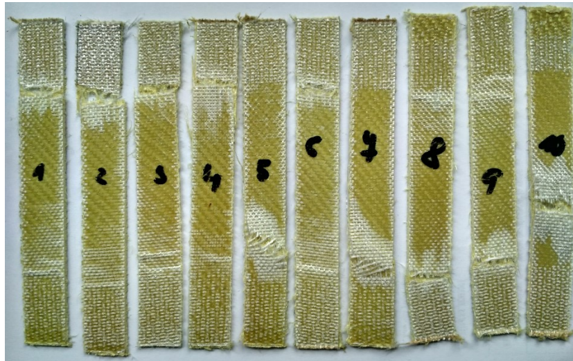
Obr. 31 Zkušební vzorky po tahové zkoušce
