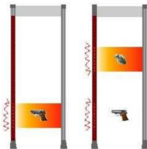
Obrázek 8 Schéma zónové detekce [12]
