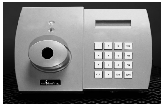
Obr. 6: Obraz sietnice a snímacie zariadenie.[2]
