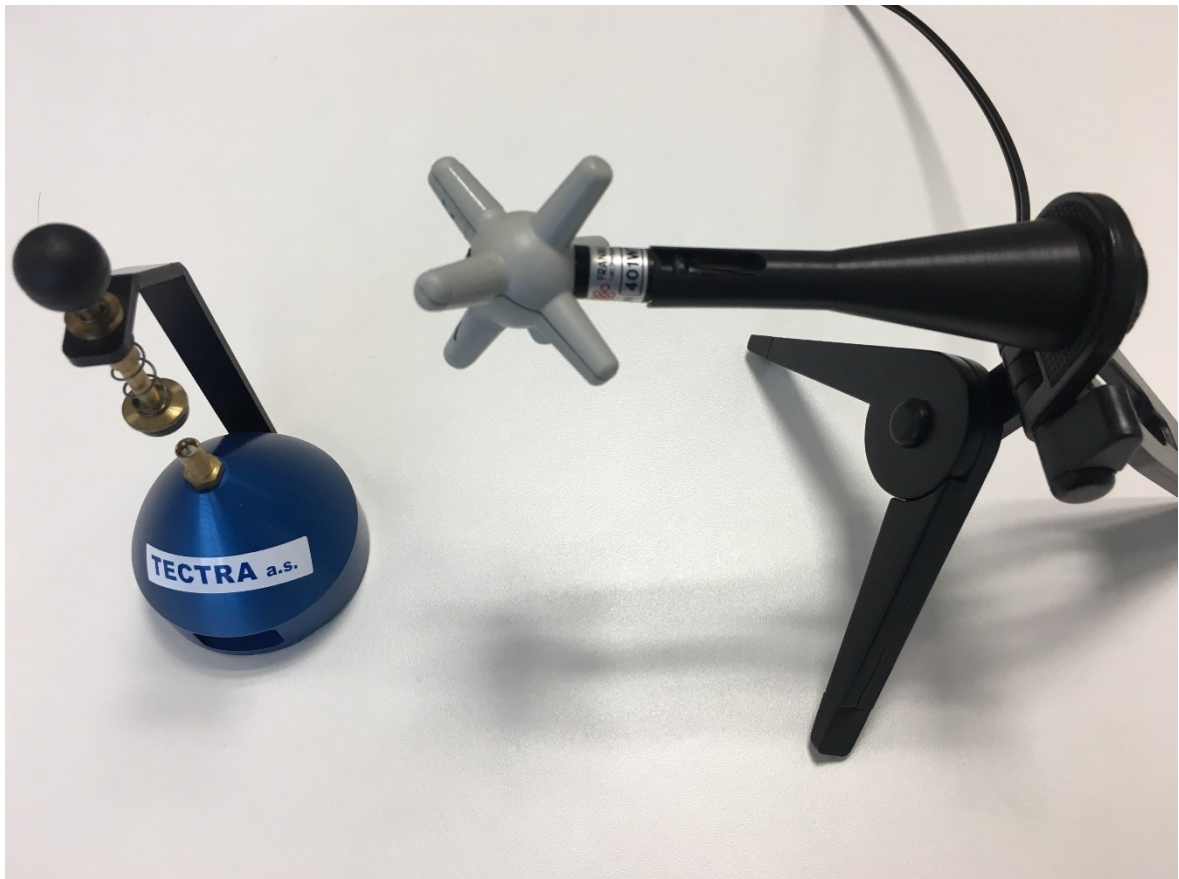
Obr. 32. Sonda pro měření intenzity pole EFS-10 společně s nabíjecí stanicí
