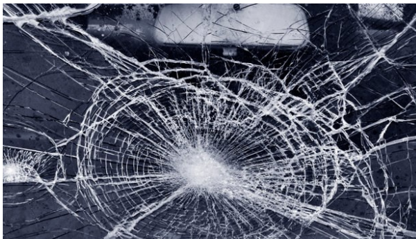
Obrázek 4 – Ukázka rozbitého vrstveného skla [12]
