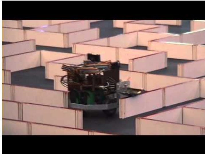
Obr. 4 První Micromouse úspěšně nalézající cíl uprostřed bludiště
