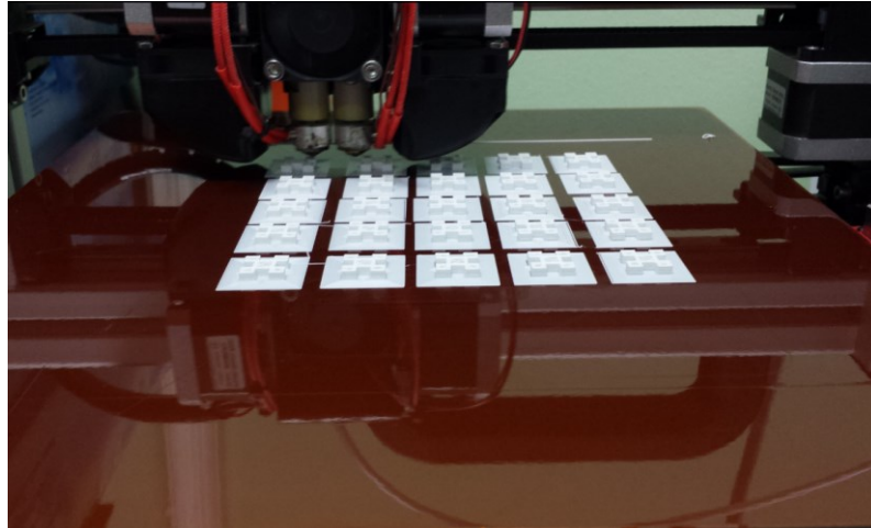
Obr. 23 Tisk sloupků na 3D tiskárně
