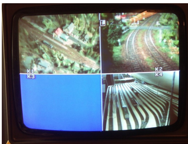
Obrázek 6 – Zobrazení kamerových záznamů s využitím kvadrátoru [16]
