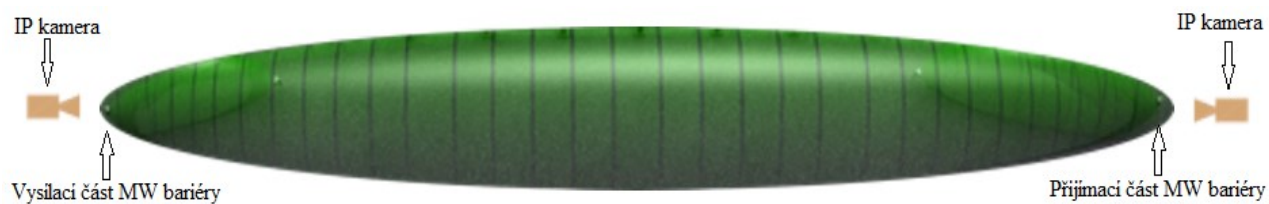
Obr. 28: Detail návrhu zapojení MW bariér s IP kamerami (upraveno a převzato z [27])
