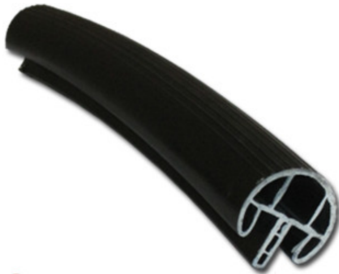
Obr. 1.4 Prohnutí profilu vlivem špatného chlazení (zdroj: Compuplast Int. a.s.)
