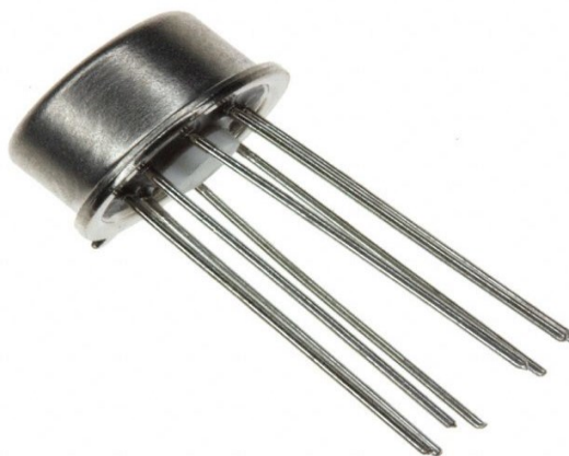
Obrázek 19 Příklad použití kovového pouzdra [18]
