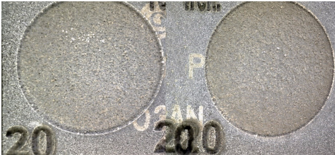
Obrázek 48 Porovnání struktury nejvyšší 200 kHz a nejnižší 20 kHz frekvence
