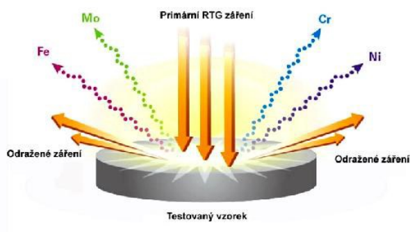
Obrázek 16 Princip rentgenové spektroskopie [3]
