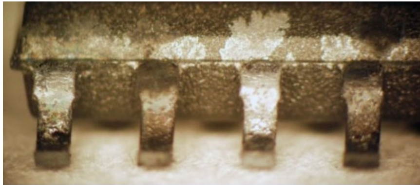
Obrázek 7 Příklad koroze nožiček a pouzdra [7]
