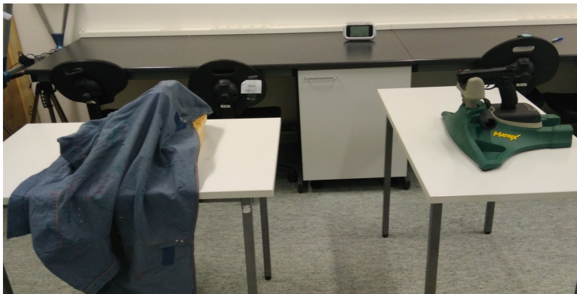
Obr. 45. Měřicí soustava pro měření balistické odolnosti textilních materiálů.
