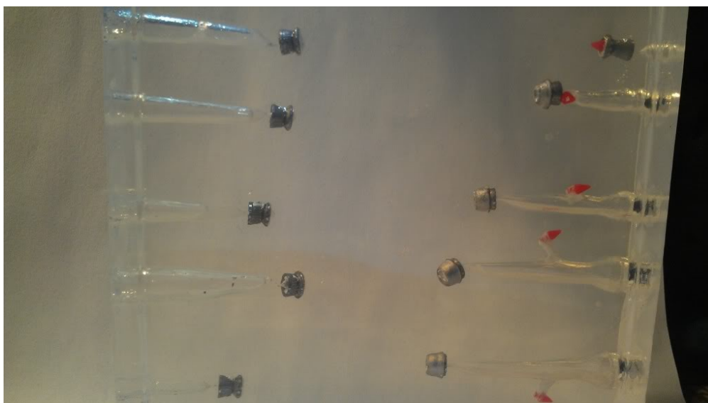
Obr. 23. Zástřely různých střel v glycerínovém mýdle [59]
