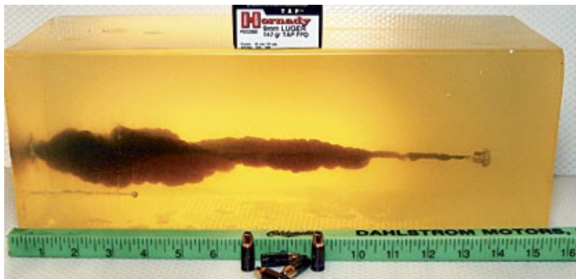
Obr. 22. Zástřel v bloku z balistické želatiny [58]
