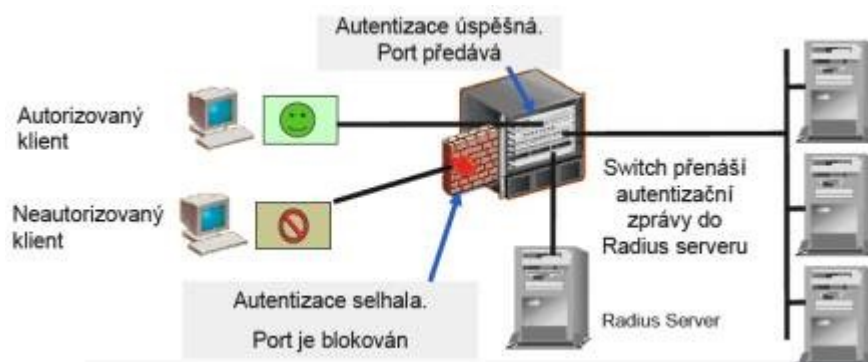
Obr. 6 – Ověření pomocí funkce NetworkLogin 802.1x [15].
