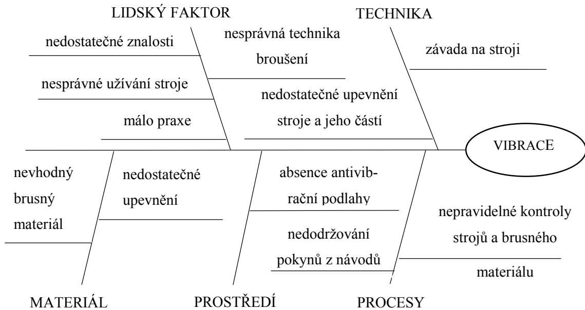
Obr. 17 – Ishikawa diagram pro příčiny vzniku vibrací [vlastní]
