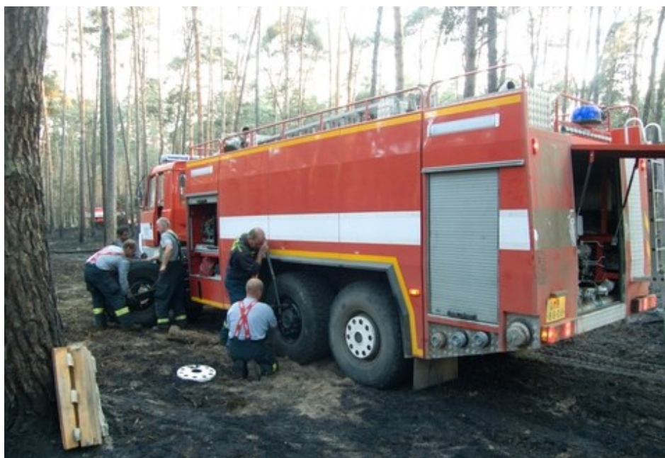
Obrázek 9. Oprava defektu na CAS. Zdroj: Archiv HZS JmK
