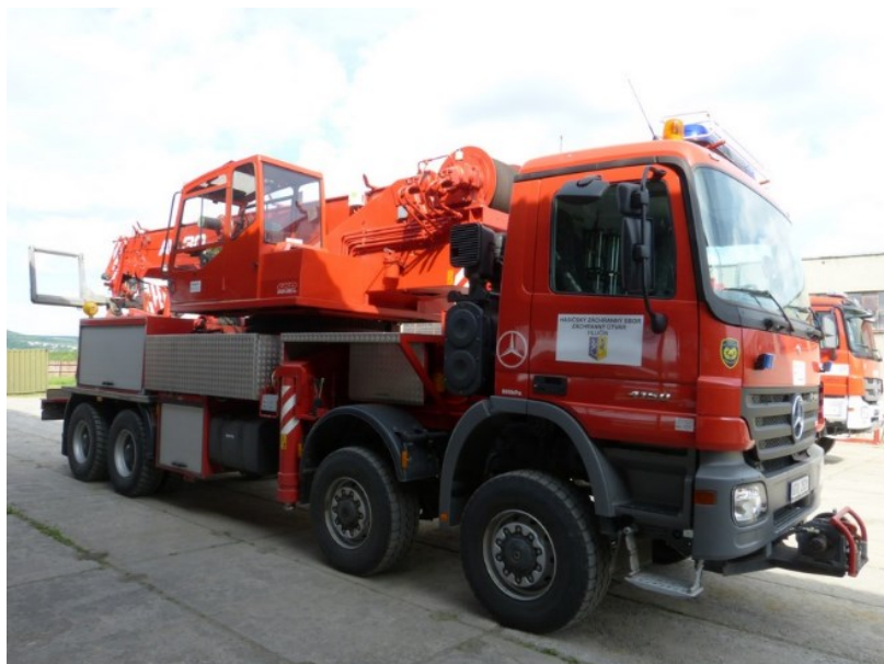
Obrázek 8. Vyprošťovací automobil VYA: AV30 s podvozkem Mercedes Actros 8 × 8. Zdroj: Archiv HZS JmK
