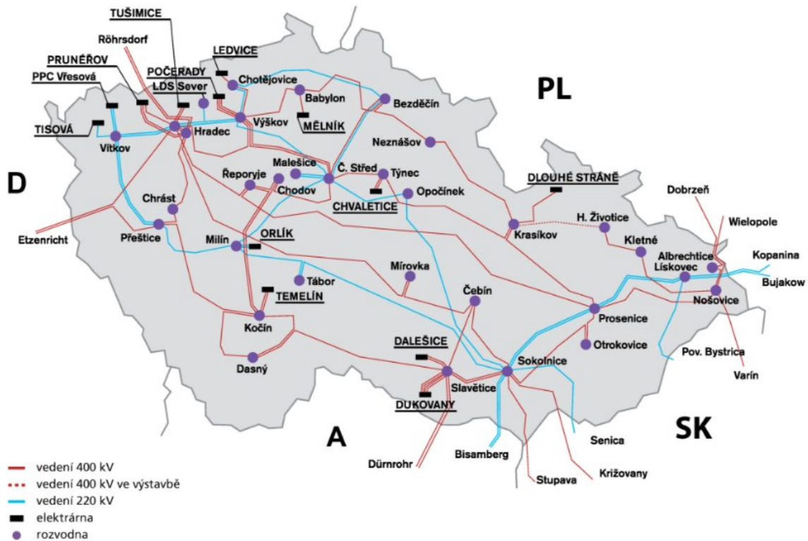
Obrázek 2 – Schéma přenosové soustavy v ČR [29]
