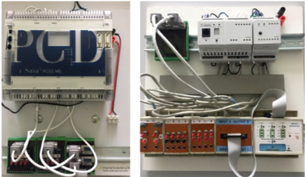
Obrázek 24. Původní stav PLC sestav SAIA(vlevo), Tecomat Foxtrot(vpravo)
