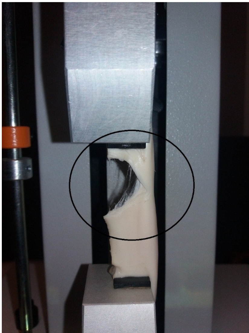
Obr. 14 Detail okamžiku perforace vzorku
