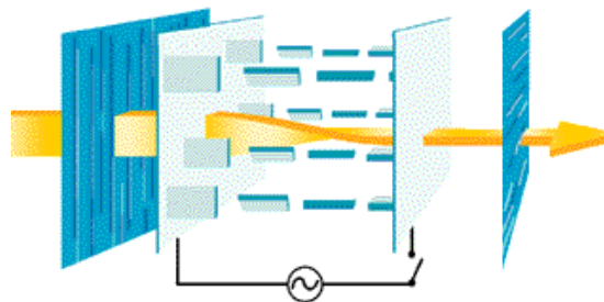
Obr. 2 - Základní stav krystalu v Twisted Nematic TFT
