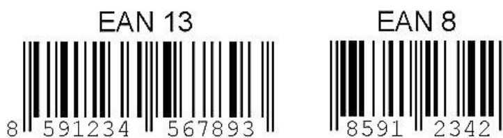
Obr. 2. Příklady čárových kódů EAN 13 a EAN 8
