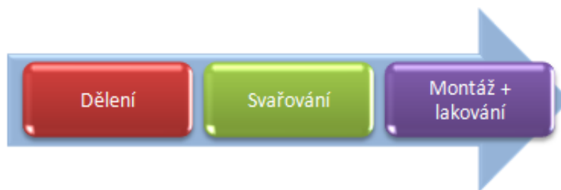
Obr. 16 Výrobní proces palet (interní informace, vlastní zpracování)
