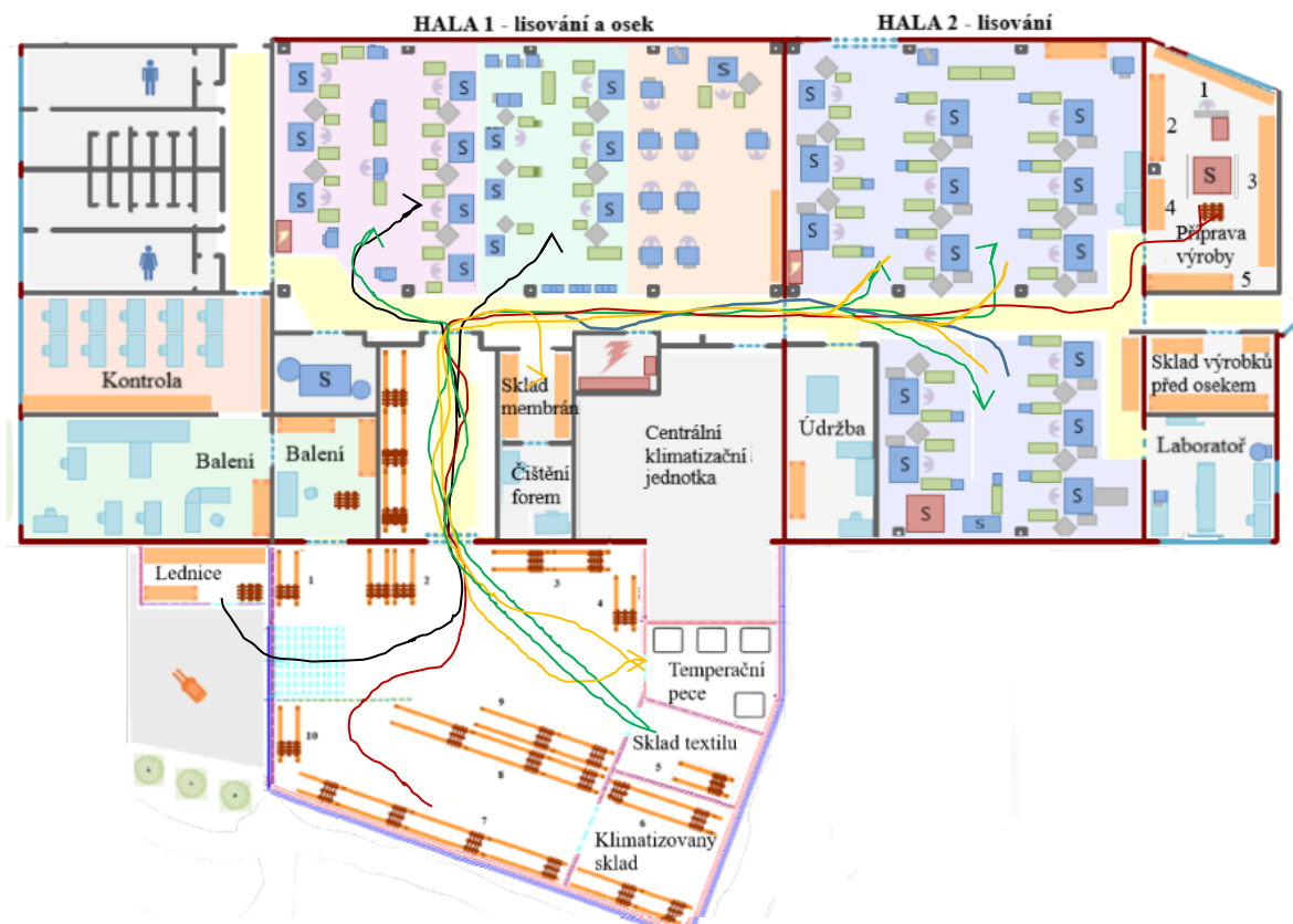
Obr. 24: Spaghetti diagram – materiálový tok ze skladu do výroby (interní zdroj - vlastní zpracování)
