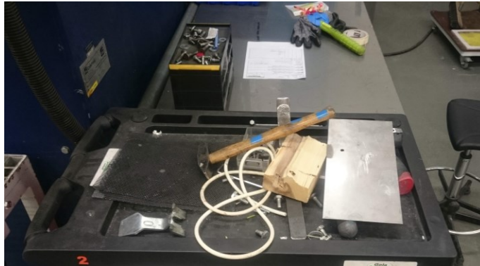
Obr. 31 Stav náradia potrebného počas výmeny pred zavedením štandardu používaného náradia (vlastné spracovanie)
