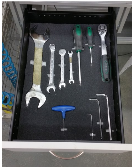
Obr. 32 Stav používaného náradia počas výmeny po zavedení štandardu používaného náradia (vlastné spracovanie)
