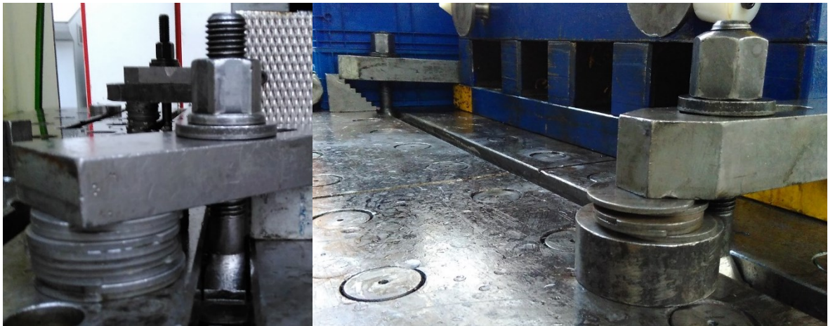
Obr. 19 Nejednotnost upínání LN (foto autor)
