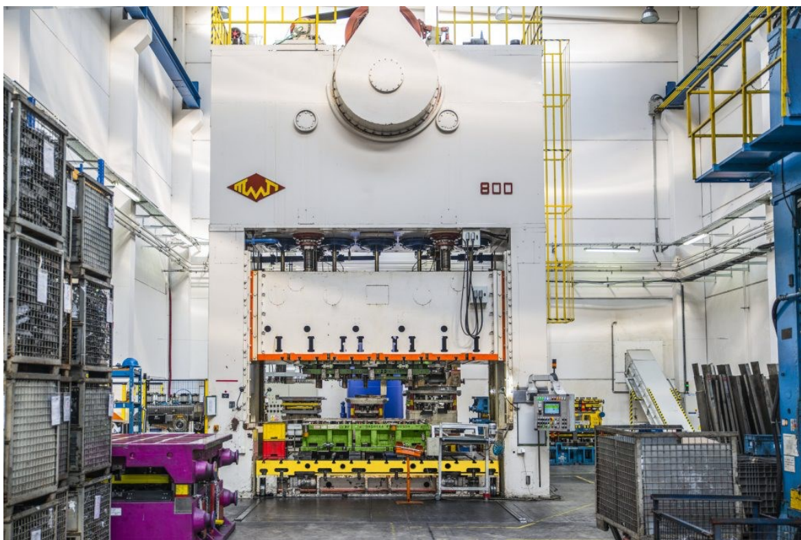
Obr. 4 Největší lis Voronež 800 t (ROSTRA s.r.o., 2017)
