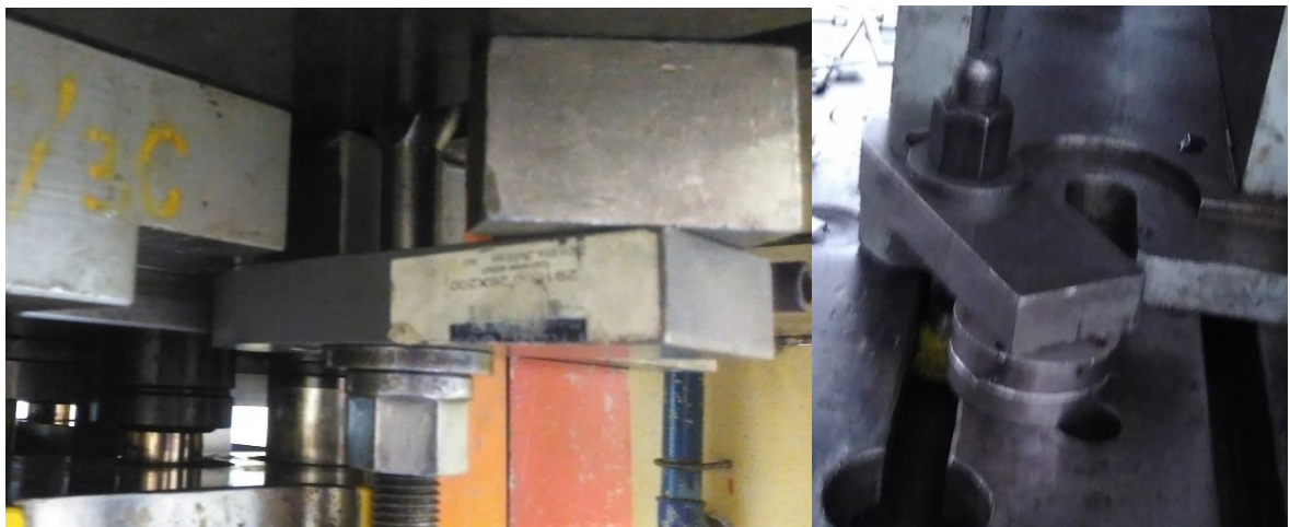
Obr. 20 Nevhodná konstrukce LN pro daný stůl lisu (foto autor)
