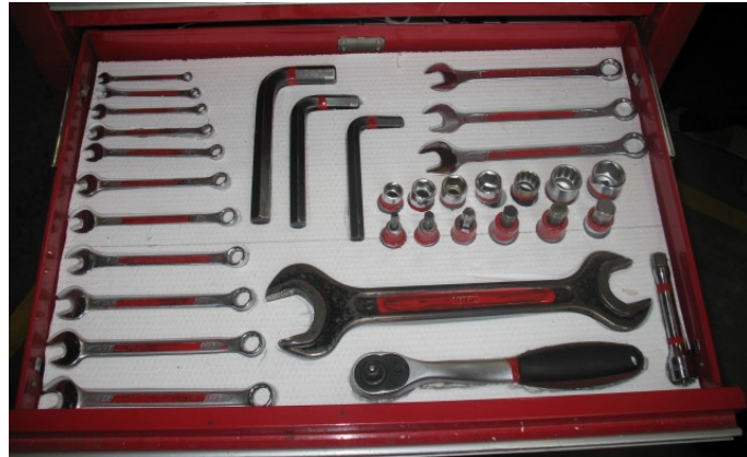
Obr. 35. Původní standardní uložení nástrojů s využitím metody 5S (Interní materiály společnosti)
