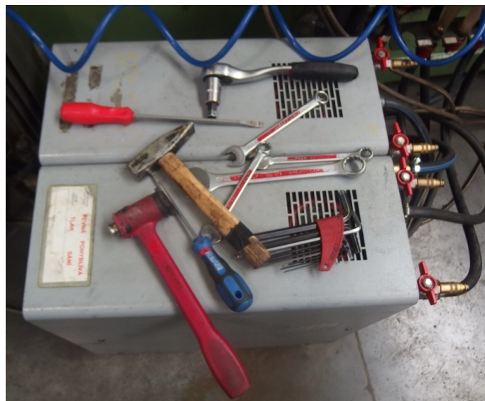
Obr. 36. Nevhodné uložení nářadí během přetypování (Vlastní zpracování)
