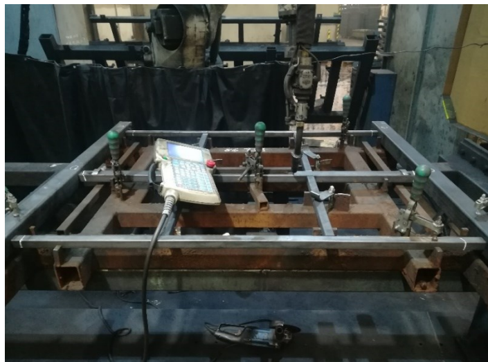
Obrázek 17 Přípravek ke svařování základny 86 B31 s učebním modulem (vlastní zpracování)
