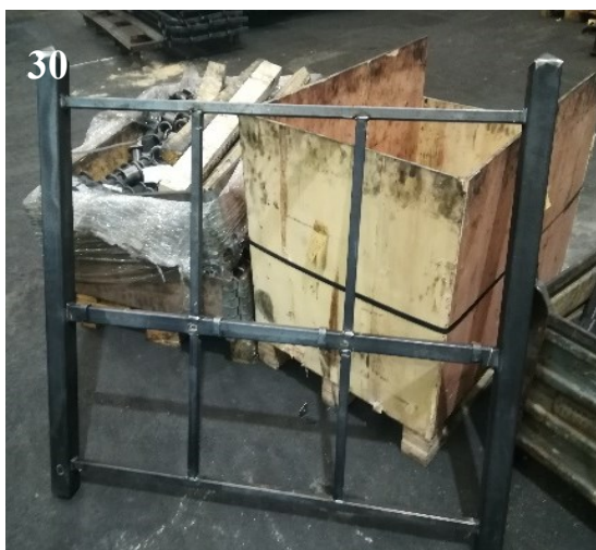
Obrázek 34 Obrázek z fotodokumentace – svařená základna - vlevo a vzhled kvalitního sváru - vpravo (vlastní zpracování)
