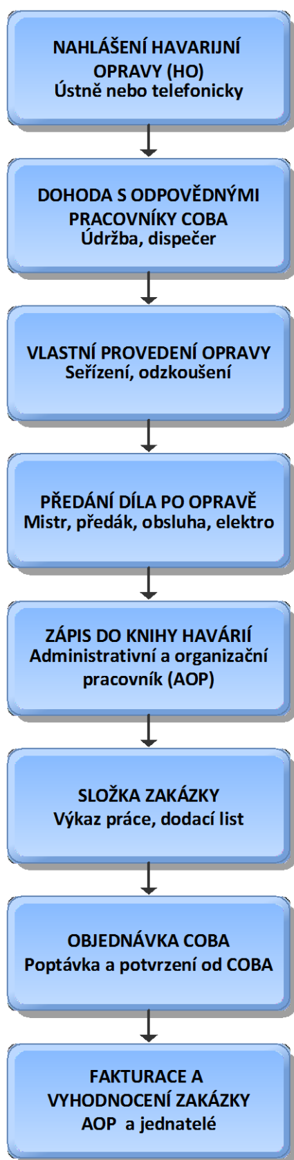
Obr. 9 Proces havarijní oprava
